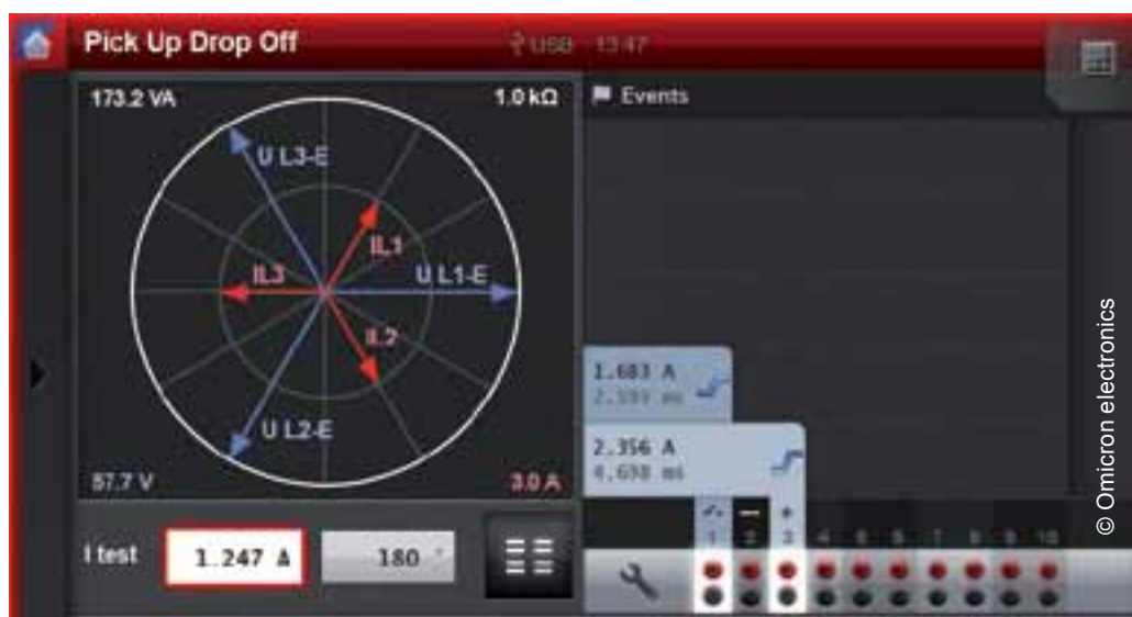
Screen zur Schwellwertprüfung von Schutzrelais
