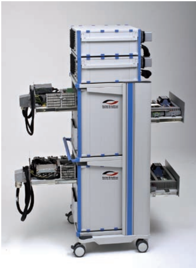
4 Plattformen wie „Messina“ von Berner & Mattner eignen sich sowohl für die entwicklungsbegleitende Absicherung von Funktionsmodellen als auch für die spätere Ausführung von SiL- und HiL-Tests
